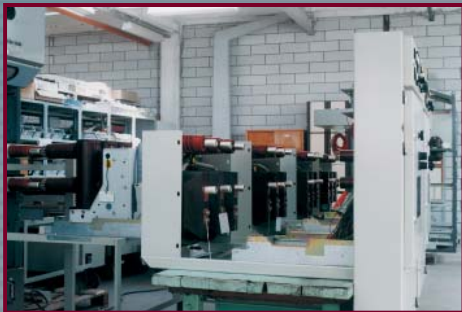
Megszakító blokkok sorozatgyártása műhelyben
